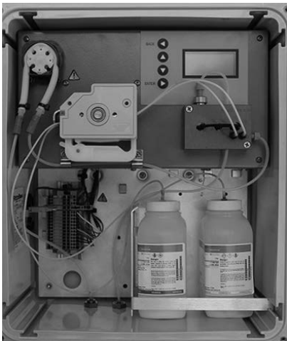
Abbildung 6: Probenpumpe mit abgenommenem Deckel dargestellt
